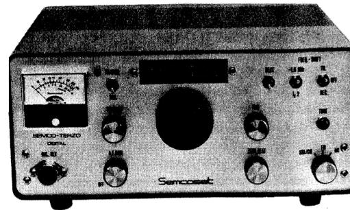
**2-m-AM/FM/SSB/CW-B-Transceiver mit digitaler Frequenzanzeige „Semco-Terzo-Digital“**
