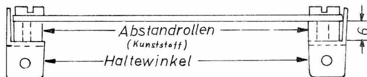
Seitenansicht einer auf die Haltewinkel aufgeschraubten Platine. Die Abstandrollen dürfen nicht vergessen werden, sonst besteht Kurzschlußgefahr.
