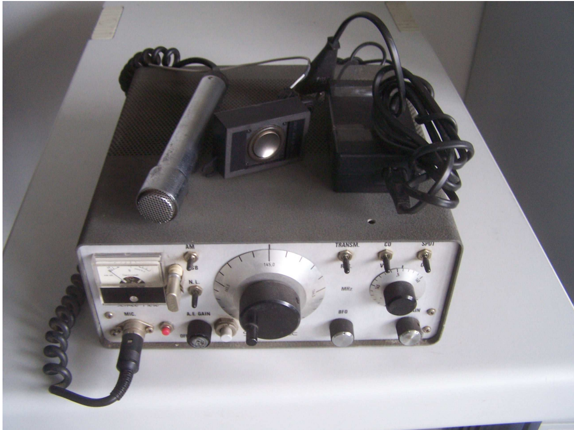
Bild 2 „mein Semco Moto“ mit Zubehör: Peiker Mikrofon, kleiner Lautsprecher, Schaltnetzteil. Der Original-Mikrofonstecker fehlt, wurde durch einen „normalen“ DIN-Rundstecker ersetzt
